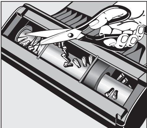
Bei hartnäckigen Verschmutzungen oder Verstopfungen im Innenraum der Handturbobürste können Sie diese öffnen. Eventuell eingesaugte Grobteile lassen sich so leicht entfernen.
